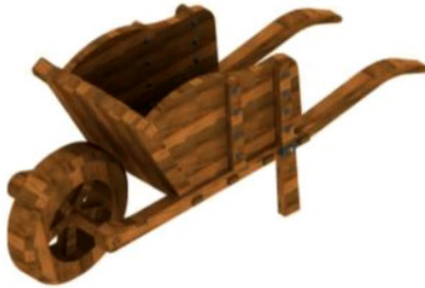
Figura 6. Carretilla de transporte de raeduras utilizada en Alcázar. Modelada por Estefanía Muñoz a partir de los modelos de Martínez Rueda (1833).
