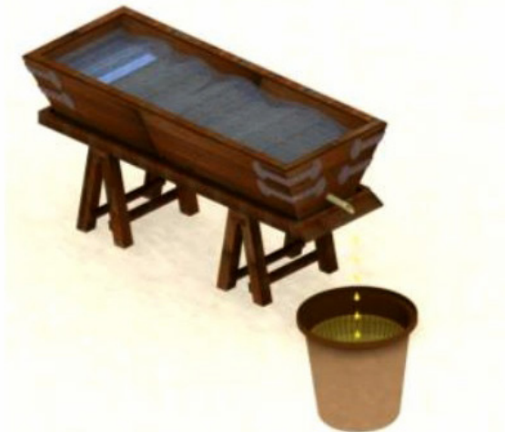
Figura 7. Artesa tipo aragonesa. Eran las coladeras que se usaban en las salitrerías de Alcázar para obtener la lejía que posteriormente se llevaría a las calderas. Modelada por Estefanía Muñoz a partir de los modelos de Martínez Rueda (1833).
