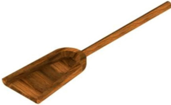
Figura 3. Pala de madera necesaria para la mover las raeduras de salitre. Modelada por Estefanía Muñoz a partir de los modelos de Martínez Rueda (1833).
