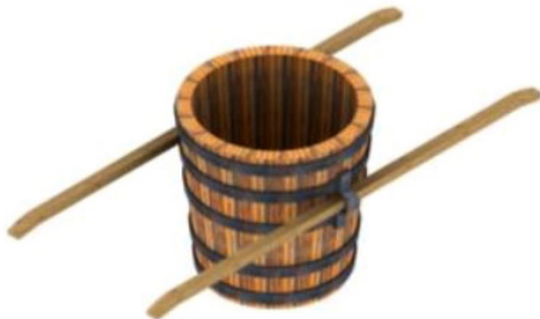
Figura 14. Cubo de trasiego utilizado para transportar el salitre cristalizado a botazos donde eliminar las impurezas. Modelada por Estefanía Muñoz a partir de los modelos de Martínez Rueda (1833).
